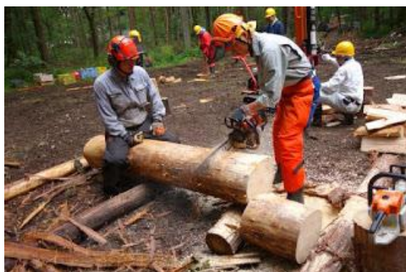
写真3-3 チェーンソーによる丸太の玉切り作業
